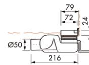
**BASIC DRAIN TILE** kanalica s rešetkom u koju se umeće pločica. Izrađen od nehrđajućeg čelika, tvornički montirana vodonepropusna tkanina, sifon sa sitom za čišćenje.
