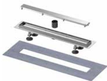
TECElinus tuš kanalica 2u1 sa sifonom (ugradna visina 95 mm) i membranskim zatvaračem neugodnih mirisa
